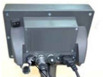
Рисунок 3 – Схема пломбировки и обозначения мест нанесения знака поверки приборов весо-измерительных МИ
